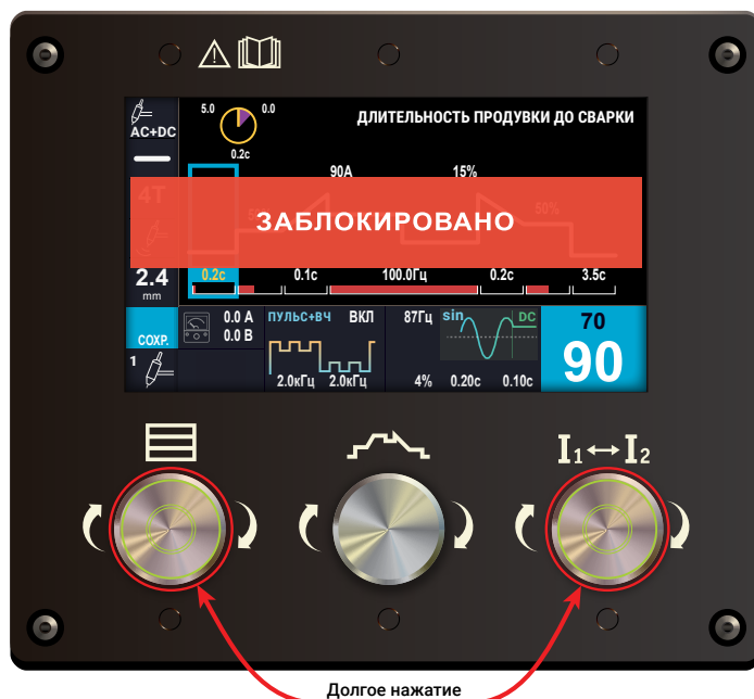
Рис. 9 — Принцип блокировки панели управления
