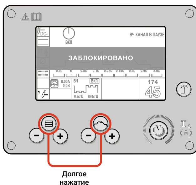
Рис. 12 — Принцип блокировки пульта ОПУ-М
